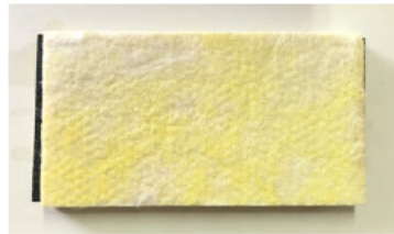
音響調整板の裏面にはグラスウール
