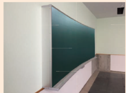
普通教室の曲面黒板です。教室の端からでも湾曲により光の反射が抑えられて見やすいことが特長です。
